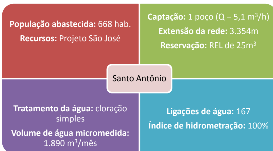
Figura 5.28 – Dados sobre o abastecimento de água da localidade de Santo Antônio, no município do Crato, de responsabilidade do SISAR.
