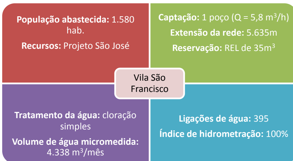
Figura 5.27 – Dados sobre o abastecimento de água da localidade de Vila São Francisco, no município do Crato, de responsabilidade do SISAR.
