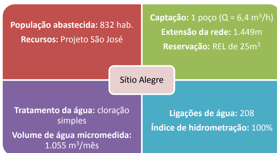
Figura 5.18 – Dados sobre o abastecimento de água da localidade de Sítio Alegre, no município do Crato, de responsabilidade do SISAR.
