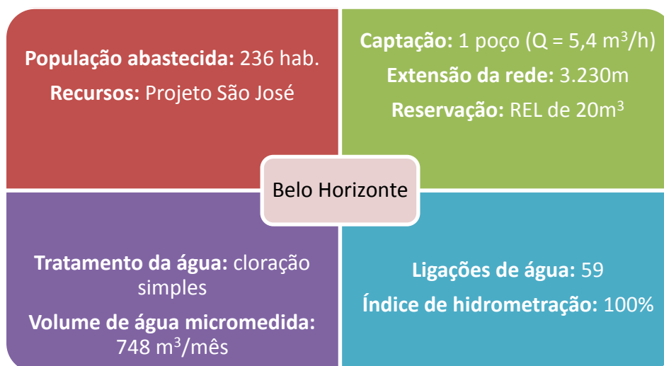
Figura 5.22 – Dados sobre o abastecimento de água da localidade de Belo Horizonte, no município do Crato, de responsabilidade do SISAR.
